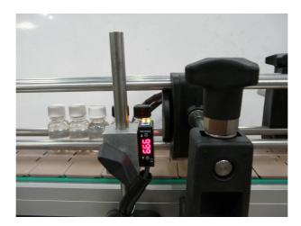
e) Mettre le produit devant la cellule, ré appuyé sur set, la cellule est réglée.
