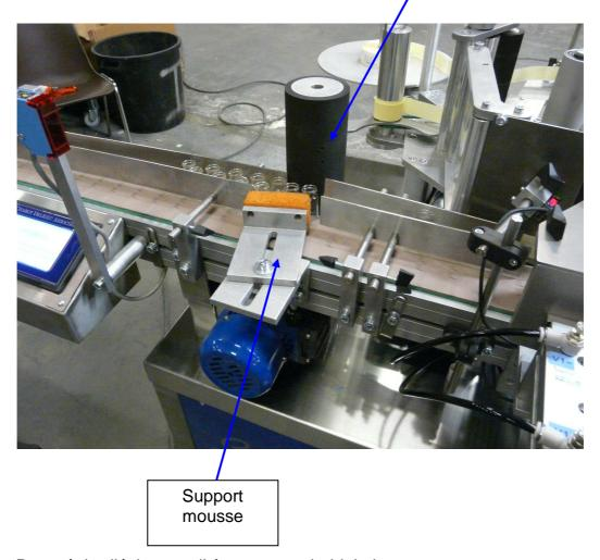
Pour régler l'éclusage, il faut mettre de biais le support mousse pour pouvoir faire entonnoir et ainsi écluser les produits.
