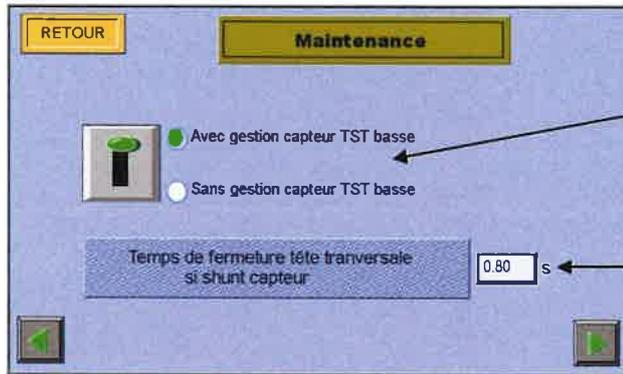
Sélection permettant d'inhiber le capteur position tête transversale ouverte.
