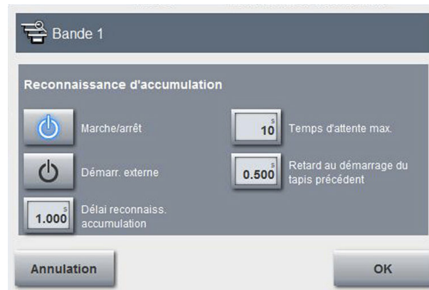
III. 199: Détection de bourrage sur tapis
