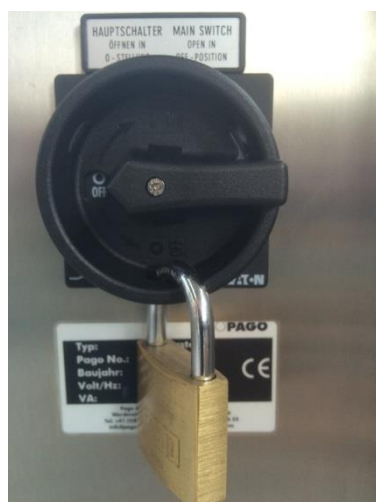
Fig. 7-1 cadenas sur l'interrupteur principal
