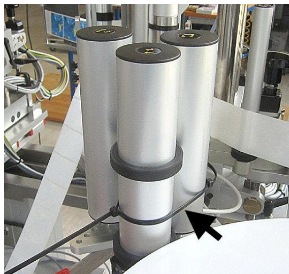
Fig. 5-3 retrait de l'attache de câbles sur le PAGOmat
