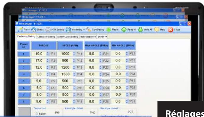
Réglages (Couple, angle, démarrage progressif et ajustement du couple)
