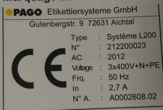
Figure 2-1: Plaque signalétique de la machine d'étiquetage
