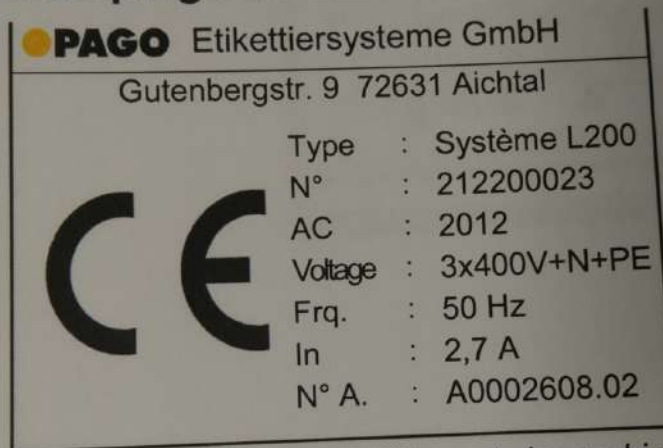
Figure 2-1: Plaque signalétique de la machine d'étiquetage
